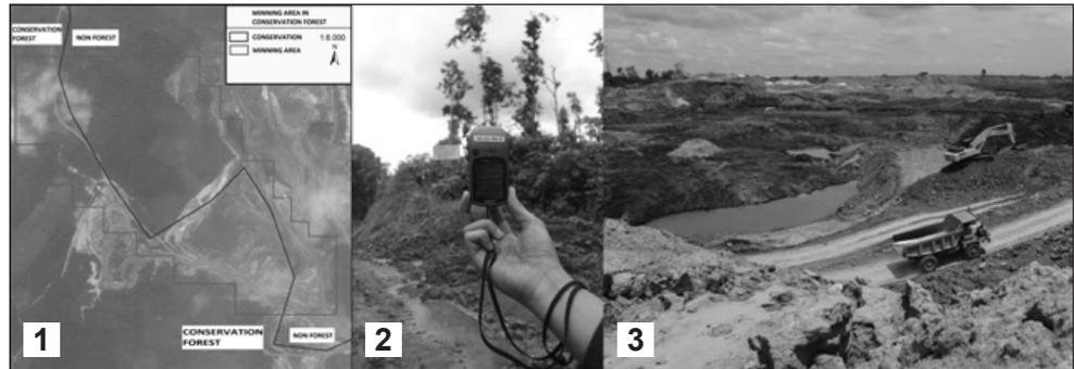
(1) El análisis GIS de un área minera en un bosque de conservación se usó en la etapa de planificación. En la etapa de trabajo de campo, la comprobación del terreno en la ubicación minera y la recolección de evidencias de auditoría se llevó a cabo usando (2) un GPS (coordenadas) y (3) una cámara (fotografías).
